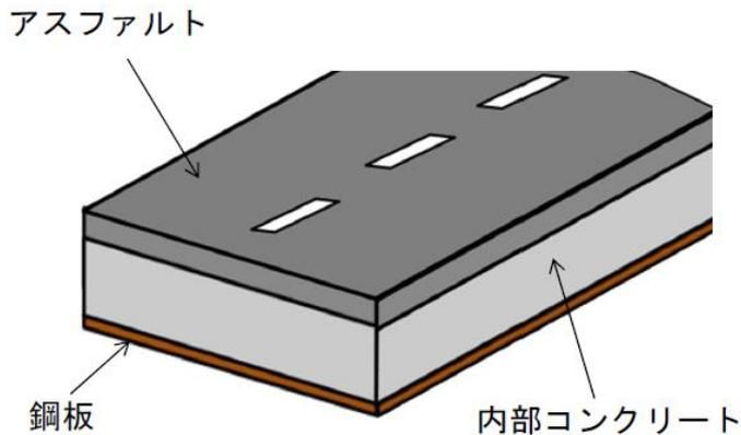
上下挟まれたRC床版(内部のコンクリート)の劣化状態(健全性)を直接的に評価できる検査手法の開発
