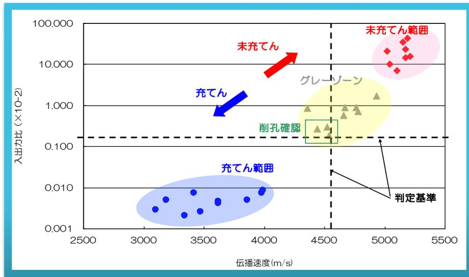
・PC鋼材を伝わった弾性波の**伝播速度**、および伝わった**エネルギー**(入出力比:[受信振幅/入力振幅])の2つの指標で評価
