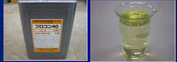
亜硝酸リチウム40%水溶液
