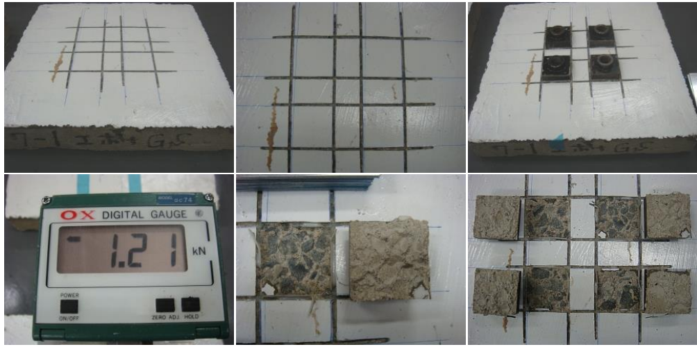
下地コンクリート破壊
