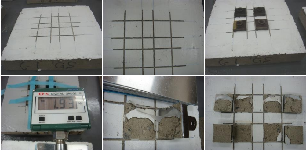
下地コンクリート破壊 & 塗膜／エポキシ系接着剤界面破壊
