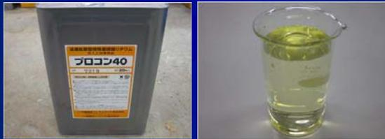
亜硝酸リチウム40%水溶液
