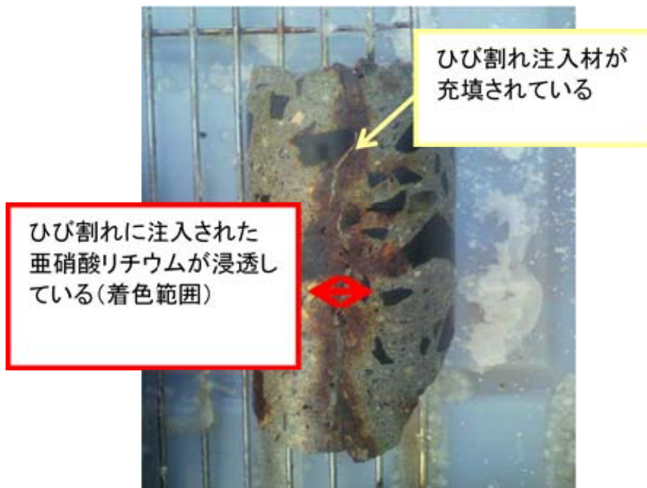
コア試料による亜硝酸リチウム浸透状況確認
