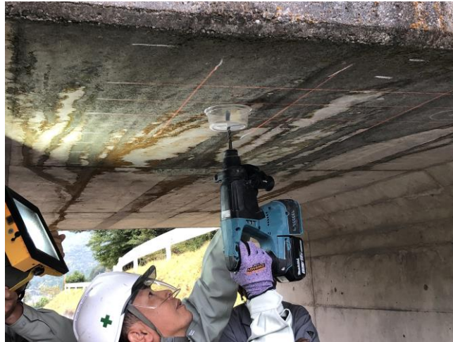
写真-1 試料採取状況（堀田3号線1号橋）
