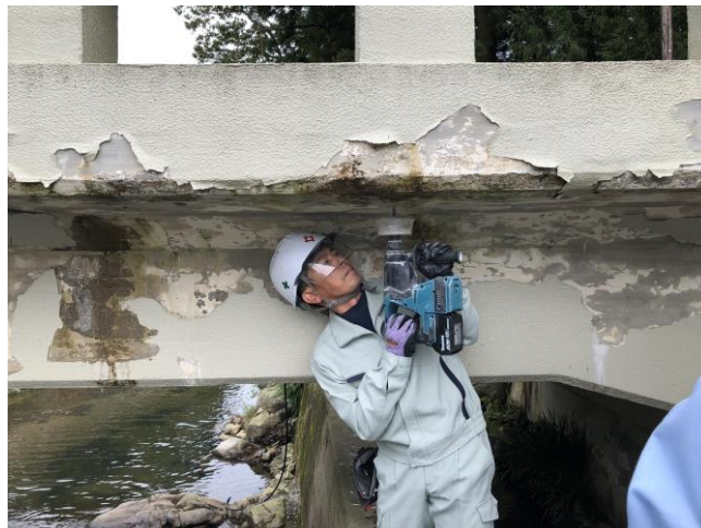
写真-2 試料採取状況（押谷橋）
