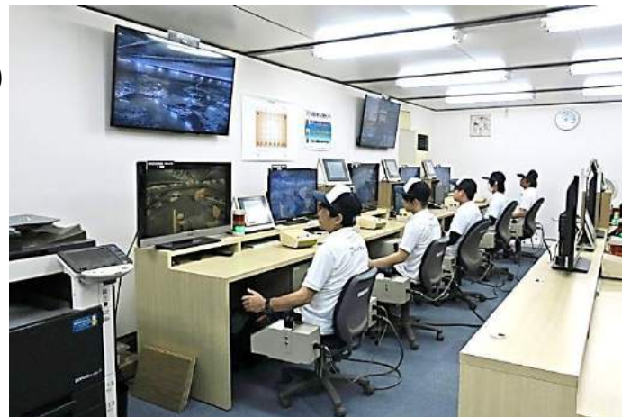
無人掘削 (遠隔操作)
