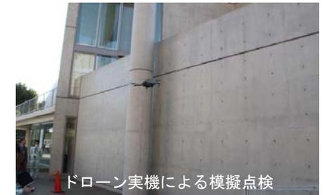
ドローン実機による模擬点検
