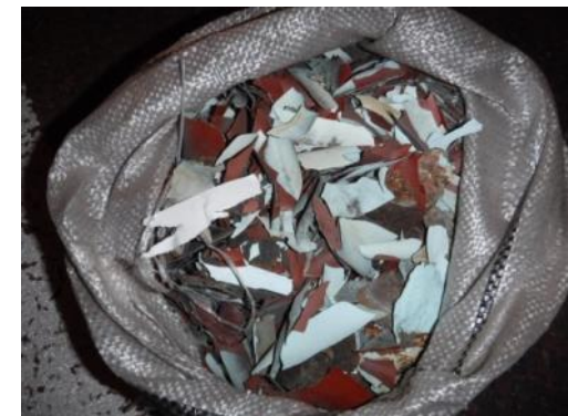
回収した腐食片
