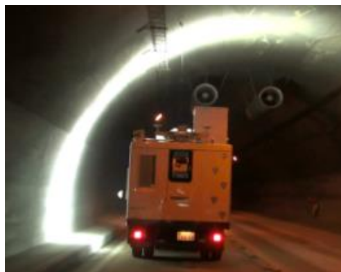
▲トンネルの変状写真を 撮影する技術
