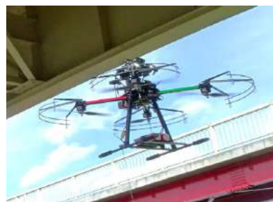
▲橋梁の損傷写真を撮影する技術
