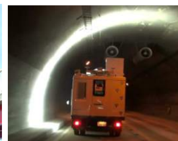
▲トンネルの変状写真を撮影する技術
