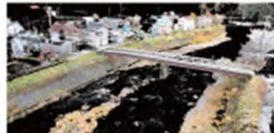
●カメラの位置・姿勢の検出 &3D点群生成(データ量大 (数百万~数千万点), 点群欠損大)
