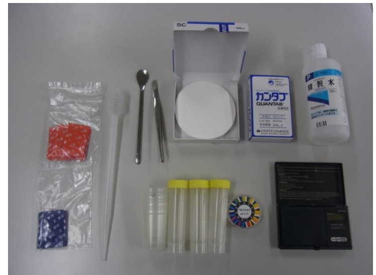
簡易塩化物イオン濃度測定器具
