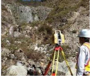
人の立入が危険な急傾斜も短時間で面的に3次元測量を実施
