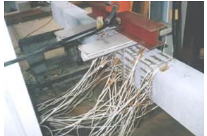
ひずみゲージ取付け 曲げ試験中
