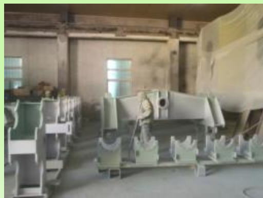
上塗材 塗装状況
