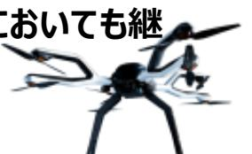
風速20m/s程度の強風下で飛行可能
