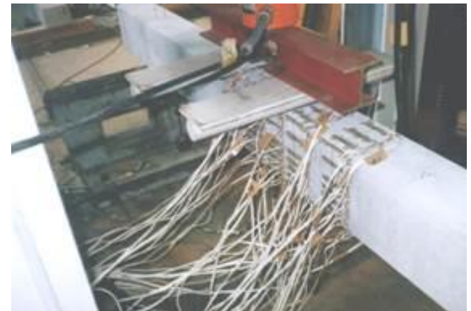
ひずみゲージ取付け 曲げ試験中
