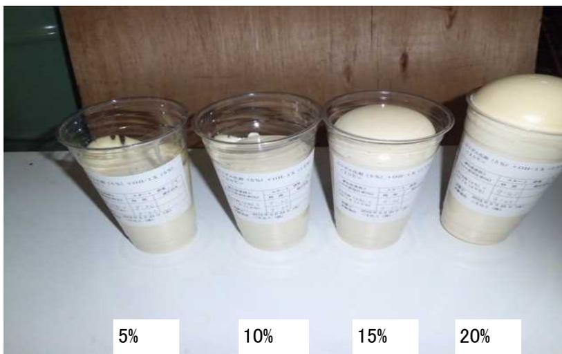
写真-1 STTG材の膨張状況
