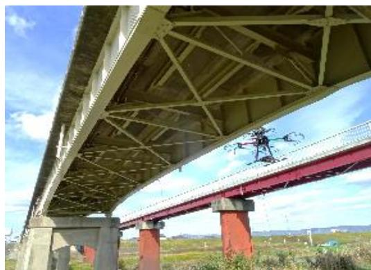
▲橋梁の損傷写真を撮影する技術
