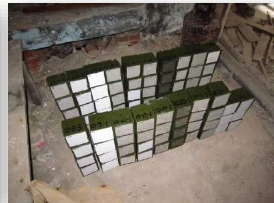
17号棟居室内 (飛来塩分がない環境)
