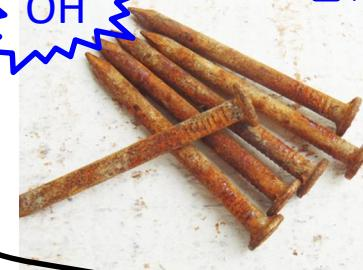
酸化鉄:さび $\text{Fe(OH)}_2$ →水分失い $\text{Fe}_2\text{O}_3$
