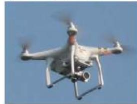
UAV(ドローン等)による3次元測量
