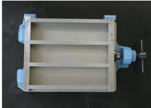
角柱供試体の型枠
