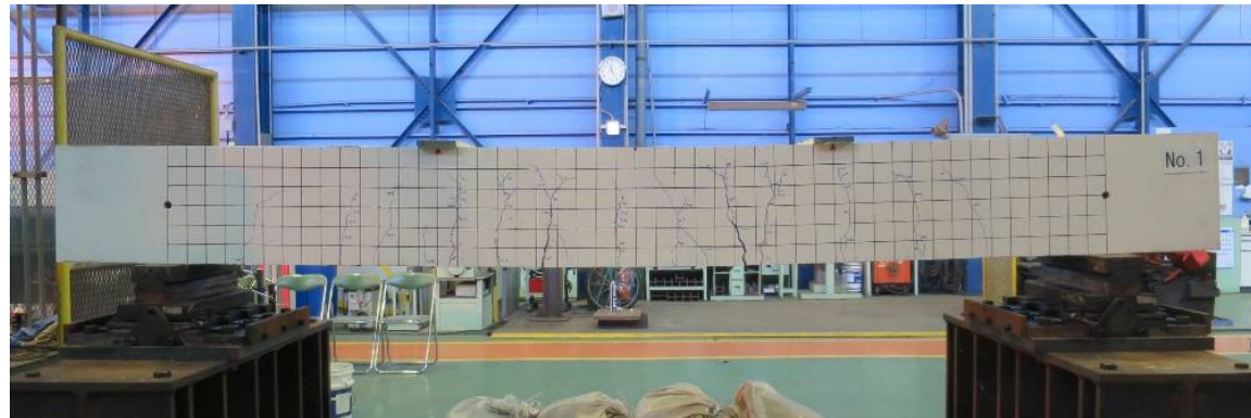
破壊後の試験体(普通鉄筋)
