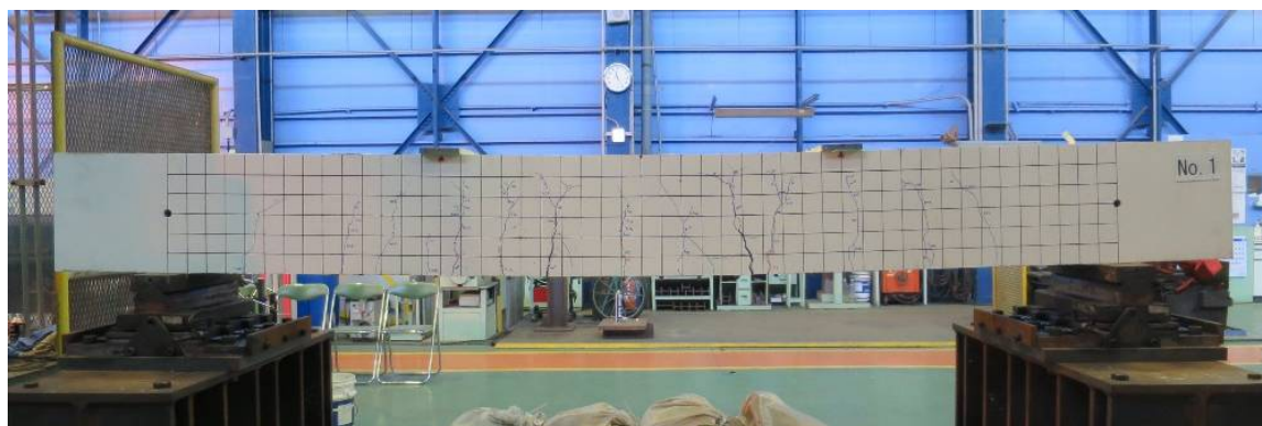
破壊後の試験体(普通鉄筋)
