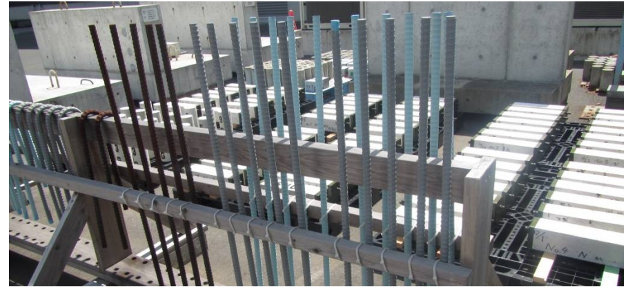
屋外暴露試験の状況
