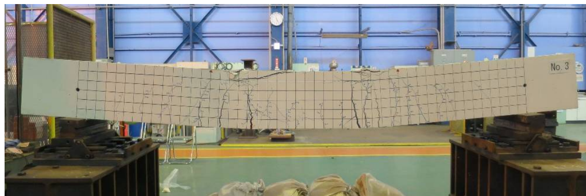
破壊後の試験体(サンドグリップバー)
