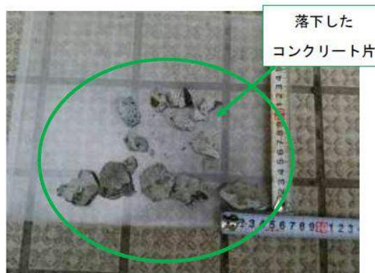
写真2 落下したコンクリート片
