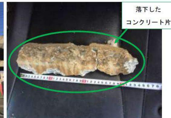
写真2 落下したコンクリート片
