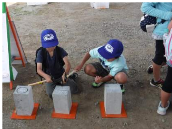
▲損傷供試体による打音確認
