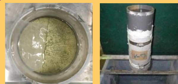
0.25mmのひび割れに油を浸漬
