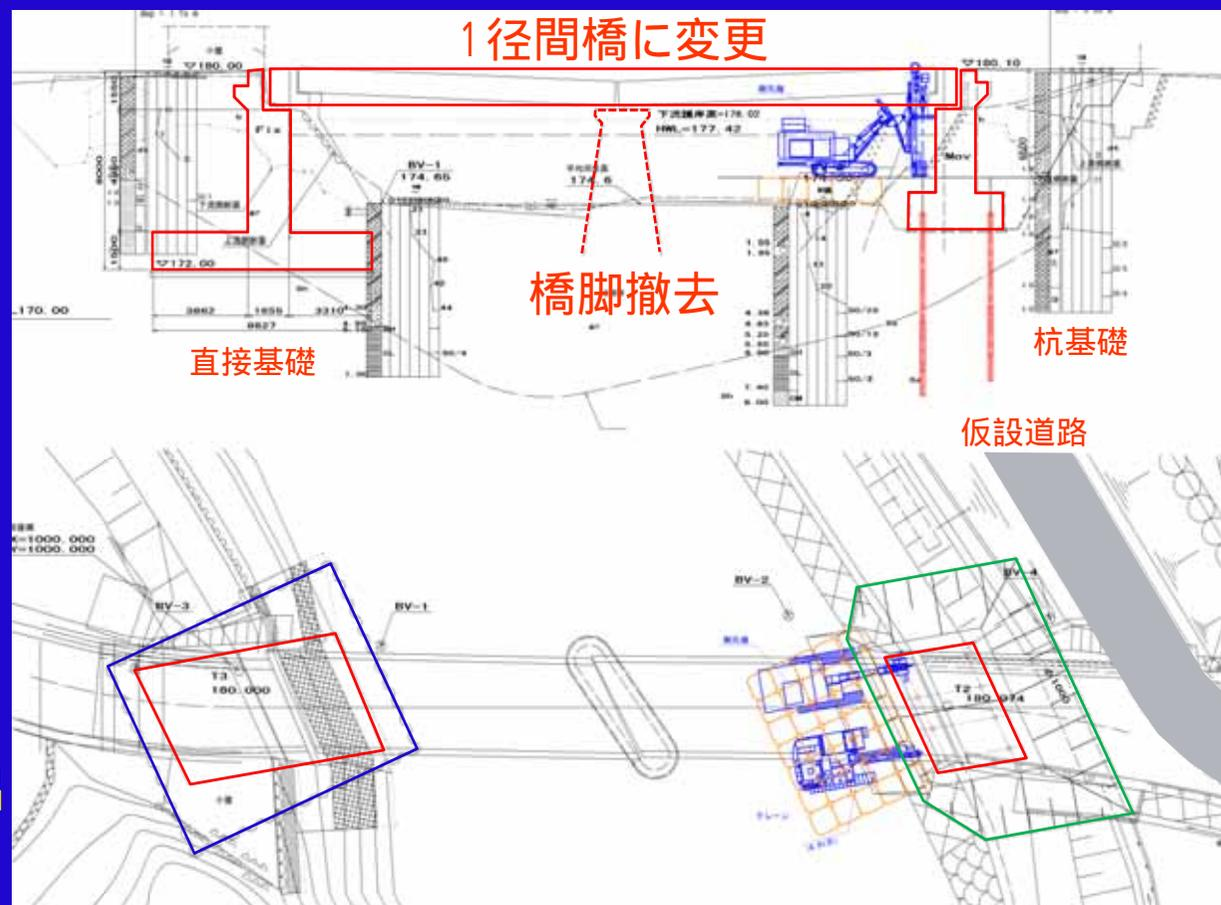
杭基礎として橋台高さを必要最小限とし、底版長さ(橋軸)を短くすることで、オープン掘削が可能となり、土留め工を省略。
