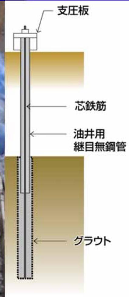
杭頭鋼管を取り付ける
