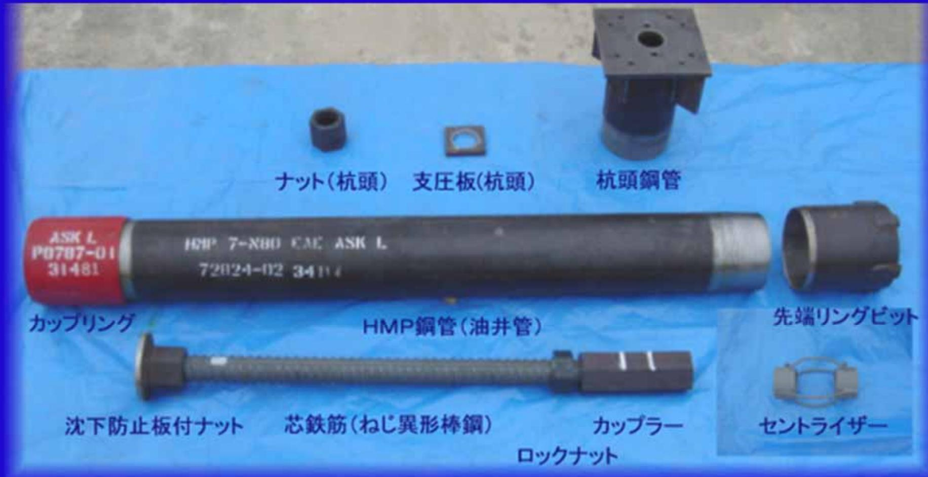
使用材料：鋼管、先端ビット、杭頭鋼管、芯鉄筋
