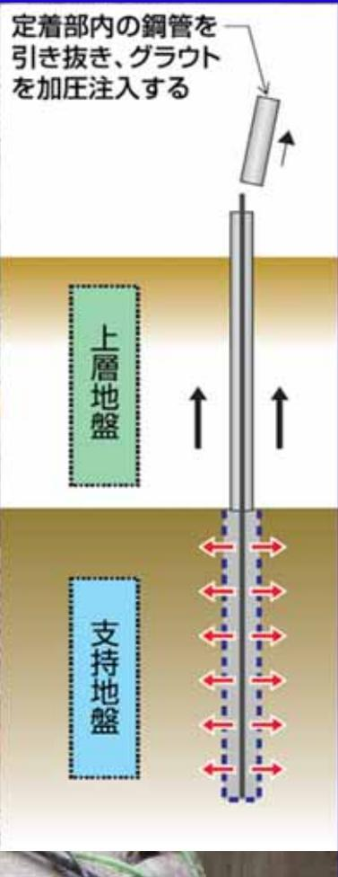
グラウトが地盤と接した状態となるよう定着長相当分の鋼管を引抜き、グラウトを加圧注入する。
