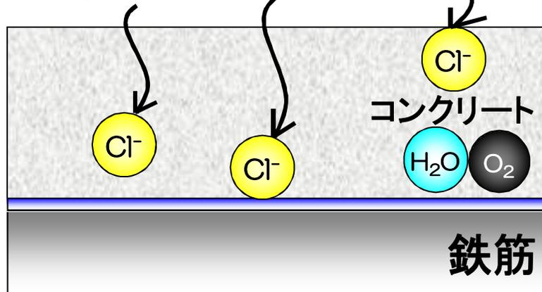
限界値以上の塩化物イオンが鉄筋近傍に到達すると不動態皮膜が破壊
