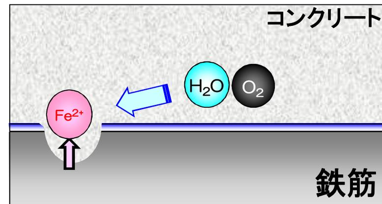
不動態皮膜が無ければ裸の鉄と同じく、腐食が進行する。
