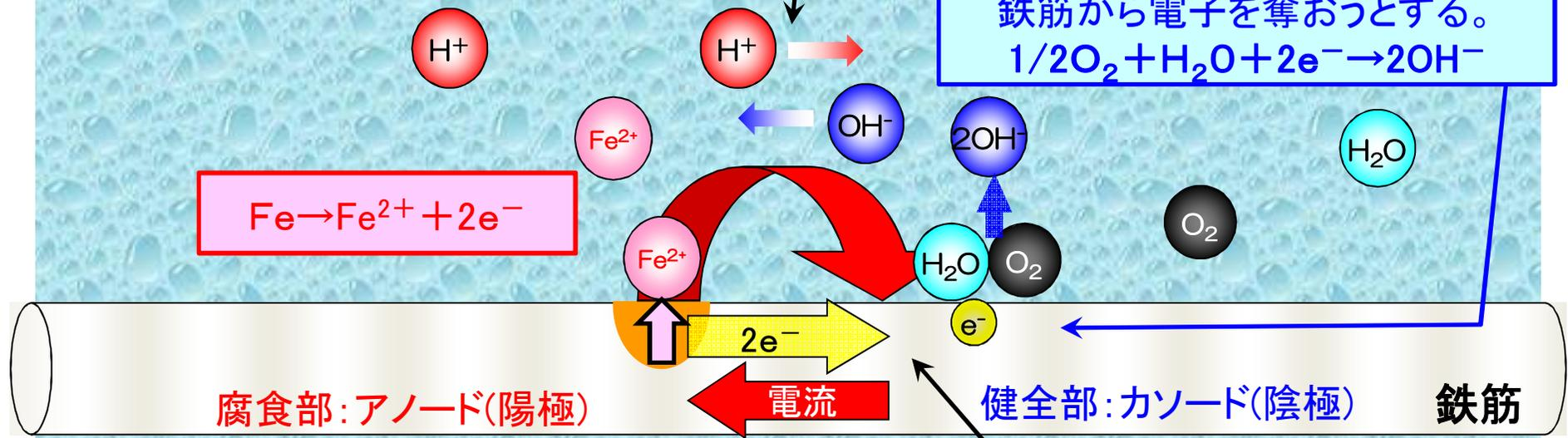
②鉄筋内では**自由電子**が動き電流の流れとなる。
