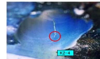
部分溶込み溶接継手のルート部の磁粉探傷試験指示模様
