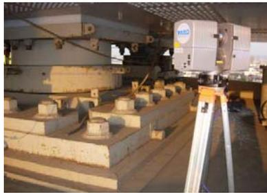
現場実測では、その実測方法の計測精度、誤差を理解しておくことが重要
