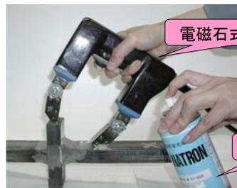
磁化および磁粉検査液の散布
