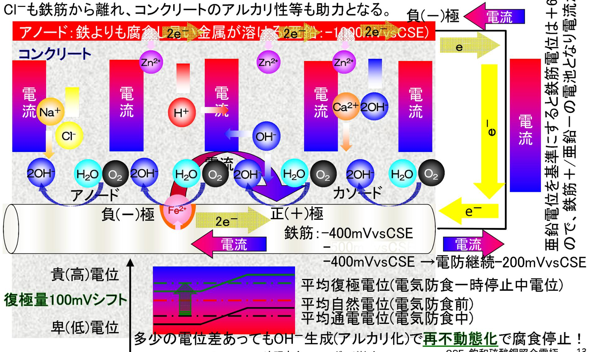
亜鉛電位を基準にすると鉄筋電位は+600mV高くなるので、鉄筋+/亜鉛-の電池となり電流が流れる
