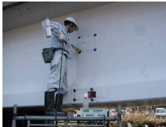
照合電極をコンクリート表面に 押し当てて電位計測
