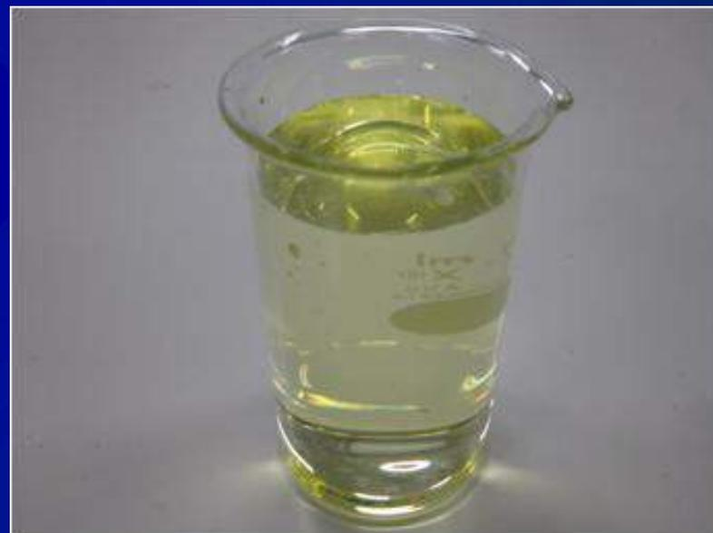
亜硝酸リチウム40%水溶液
