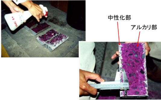
フェノールフタレイン1%溶液による中性化試験
