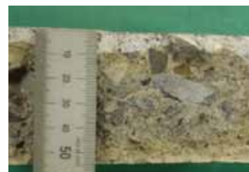
内部への含浸深さ(基板:コンクリート板の場合)
