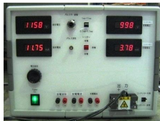
定電圧定電流発生装置
