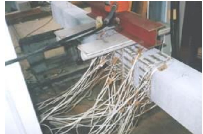
ひずみゲージ取付け 曲げ試験中
