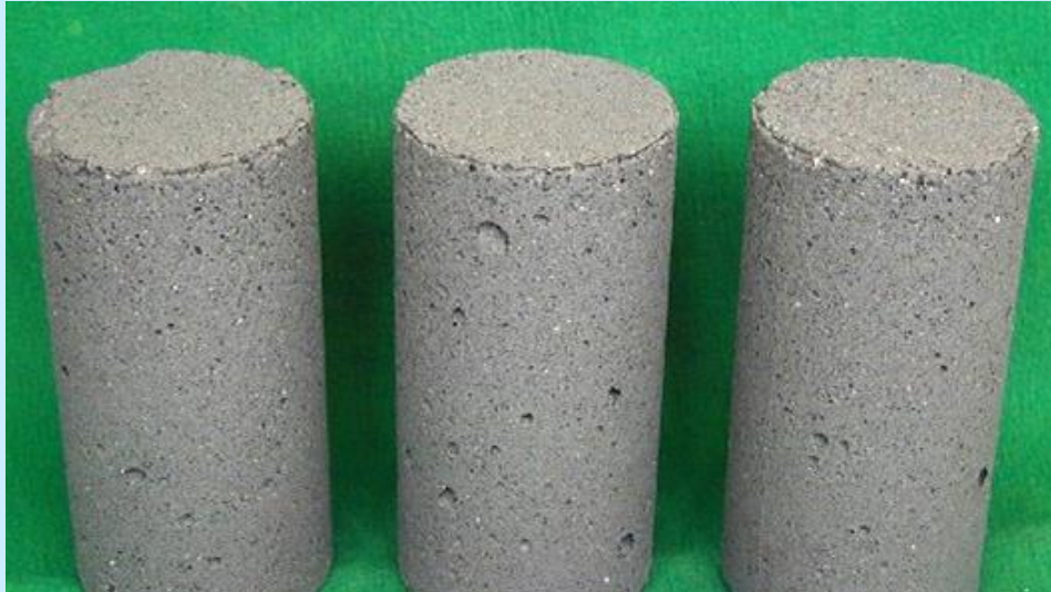
耐酸コンクリート (質量変化率 +1%)
