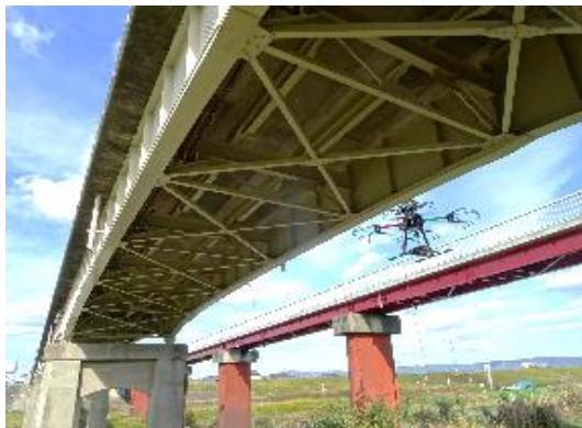
▲橋梁の損傷写真を撮影する技術
