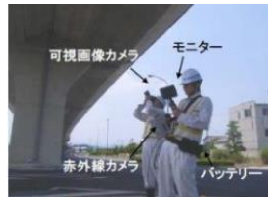
赤外線調査トータルサポートシステム（Jシステム） （NETIS：SK-110019-V）
