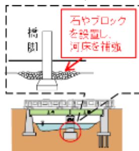
鉄道河川橋梁の基礎部分の補強
