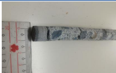
粗骨材を除くことで精度向上
