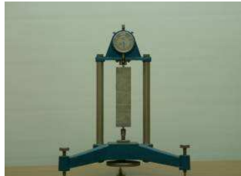
長さ変化試験の測定状況例
