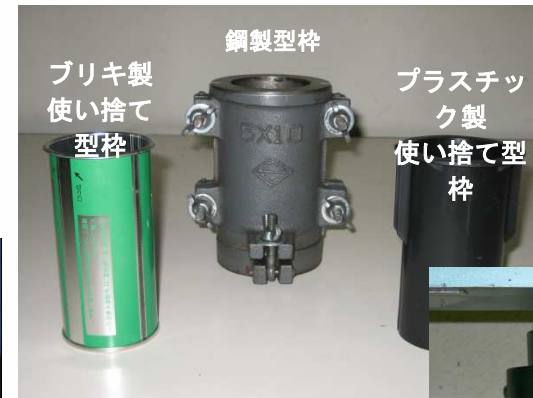
円柱供試体の型枠
