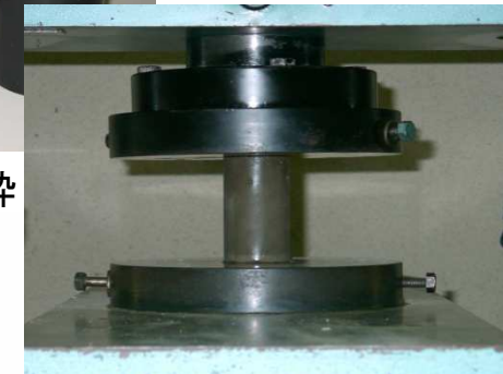
円柱供試体による測定状況
