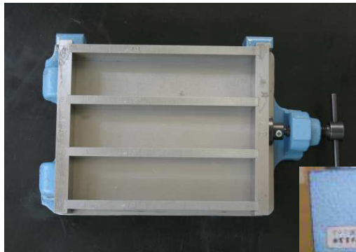
角柱供試体の型枠
