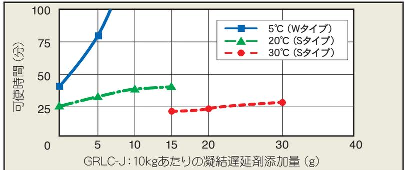
注) ライオンGRLC-Jには、冬用タイプ(5~20°C)と夏用タイプ(20°C以上)の2種類があります。ご使用になる気温に合わせて使い分けを行い、タイプに合わせて凝結遅延剤(ジェットセッター)の添加量を決定してください。
