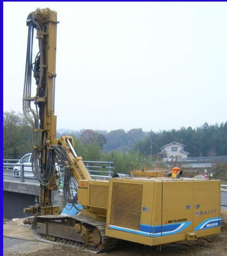
H=3.9m : 適用鋼管長 1.0m
