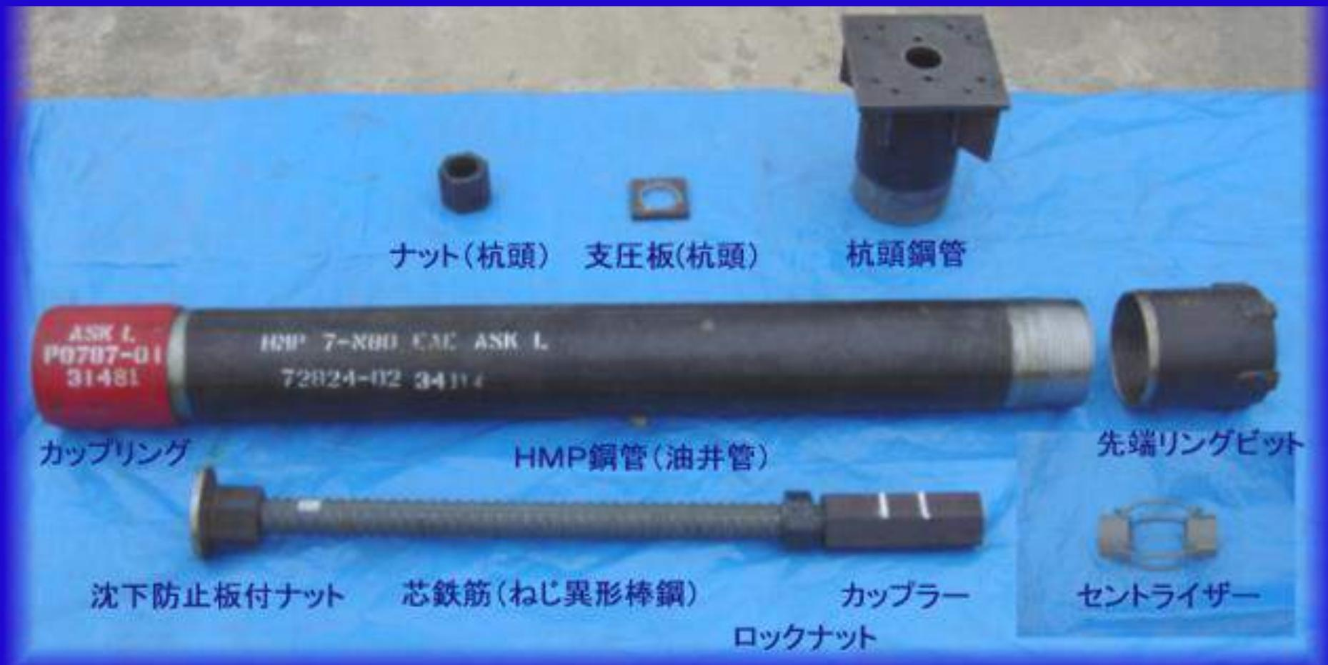
使用材料：鋼管、先端ビット、杭頭鋼管、芯鉄筋
