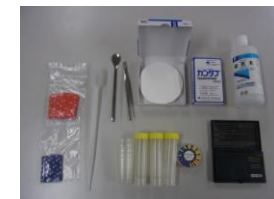
簡易塩化物イオン濃度測定器具
