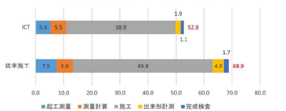
起工測量 ~ 完成検査までの合計時間(平均)
