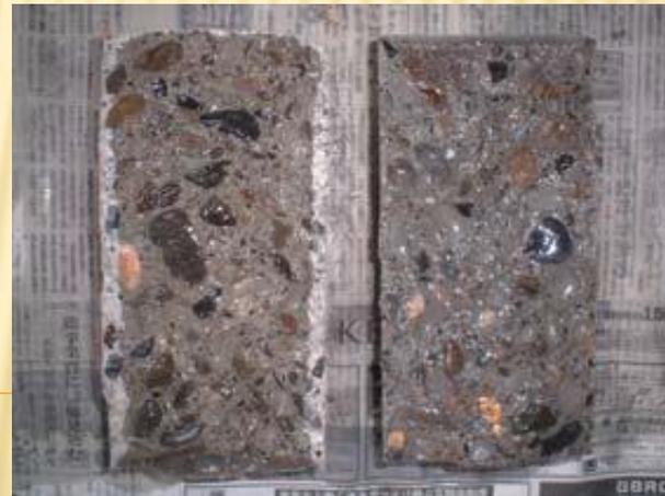
吸水防止層の確認（円柱型供試体）
