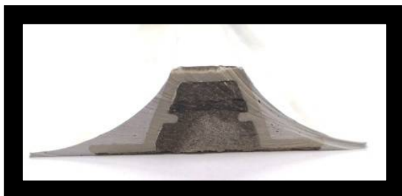
グラウト充填状況
