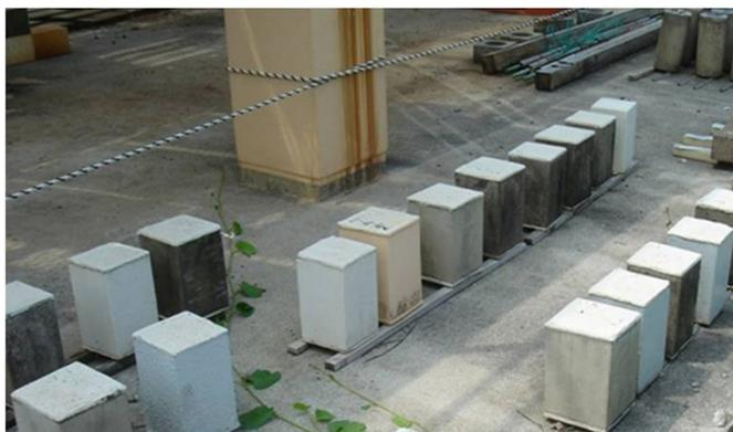
試験体の曝露状況
