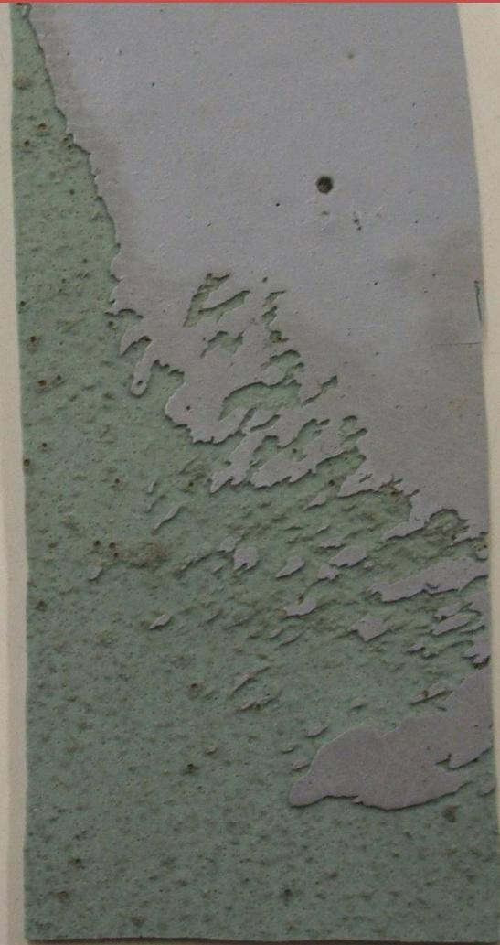
トップコートの塗り残し部分の防水層が風化した様子
