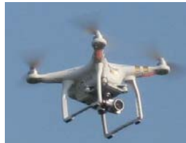
UAV(ドローン等)による3次元測量
