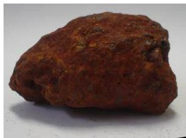
酸化鉄:鉄鉱石 $\text{Fe}_2\text{O}_3$
