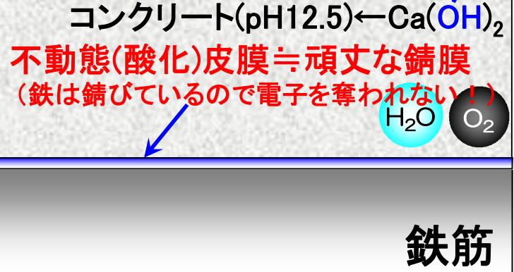
限界値以上の塩化物イオンが鉄筋近傍に到達すると不動態皮膜が破壊
