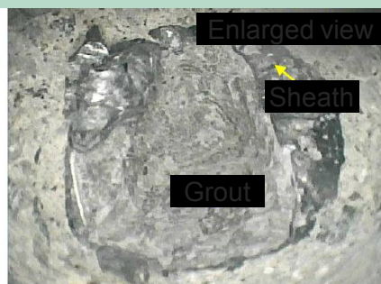
削孔+CCD 充填確認
