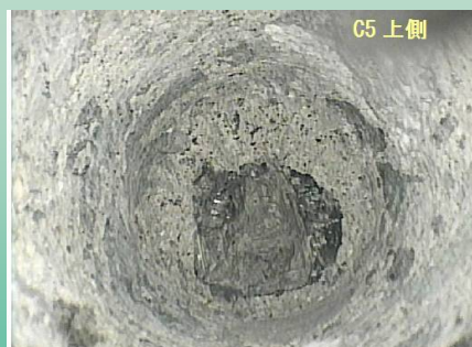
削孔+CCD 充填確認
